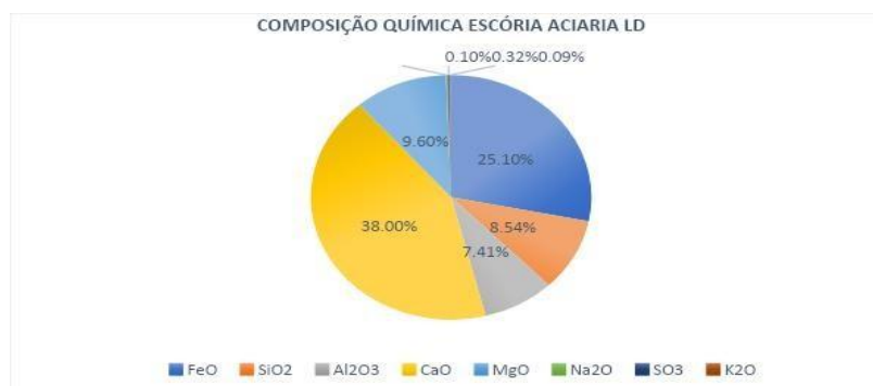
Gráfico 1: De acordo com dados retirados PACHECO (2017), as porcentagens da composição química das escórias aciaria LD no estado natural.
