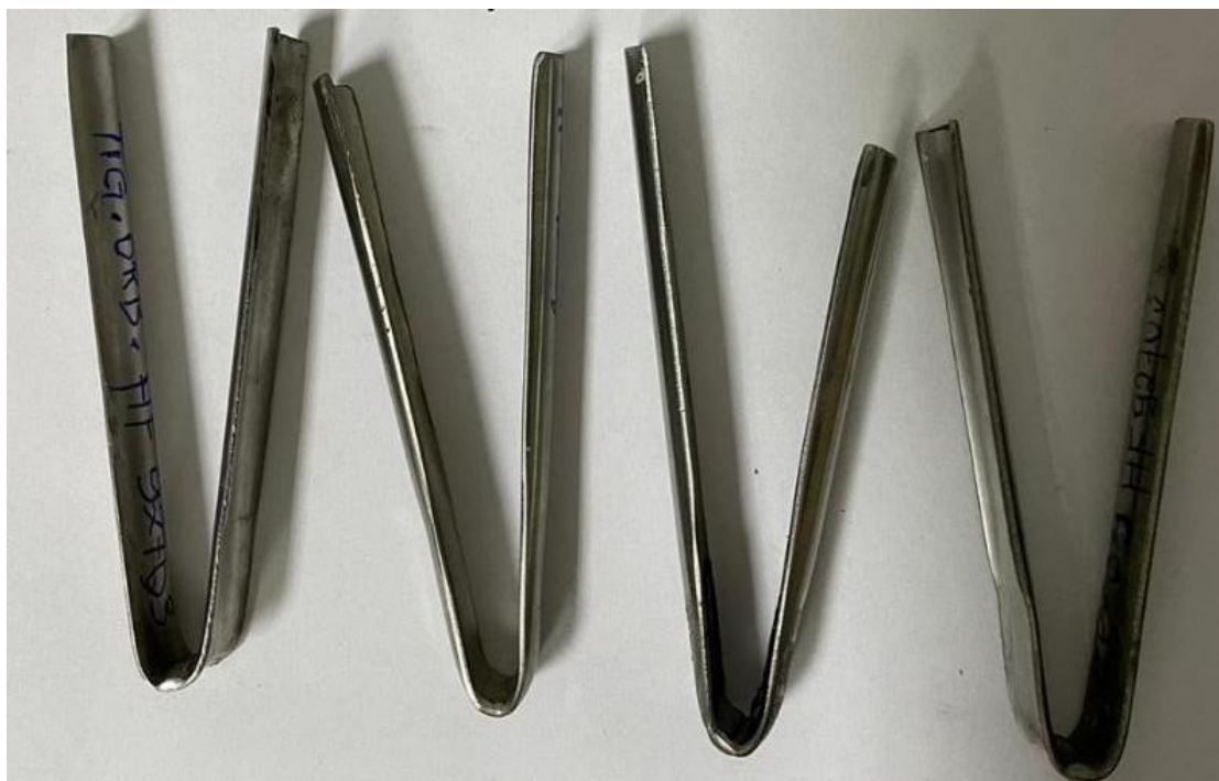
Figura 4 – Corpos de prova após ensaio de dobramento.
