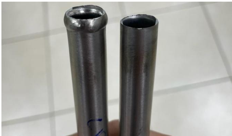
Figura 3 – Resultado de ensaio de tração (CP 2).
