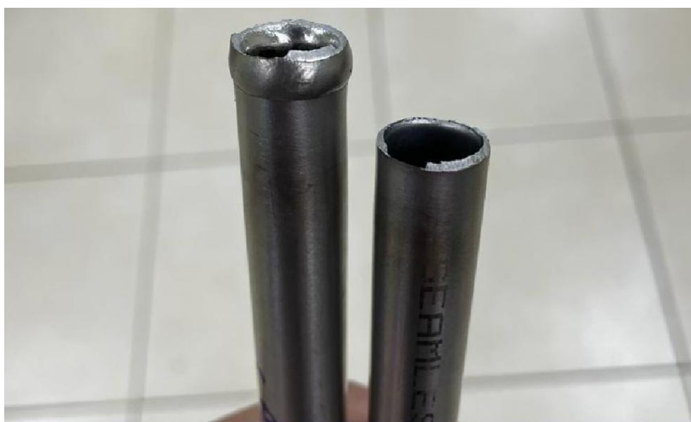
Figura 2 – Resultado de ensaio de tração (CP 1).
