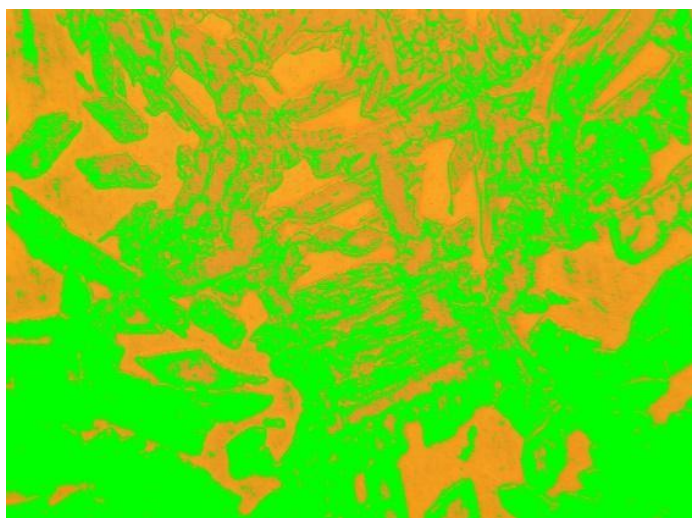
Figura 8 – Metalografia na região da solda.
