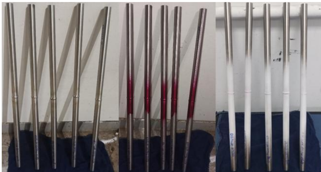
Figura 2 – Execução de ensaio de líquido penetrante.
