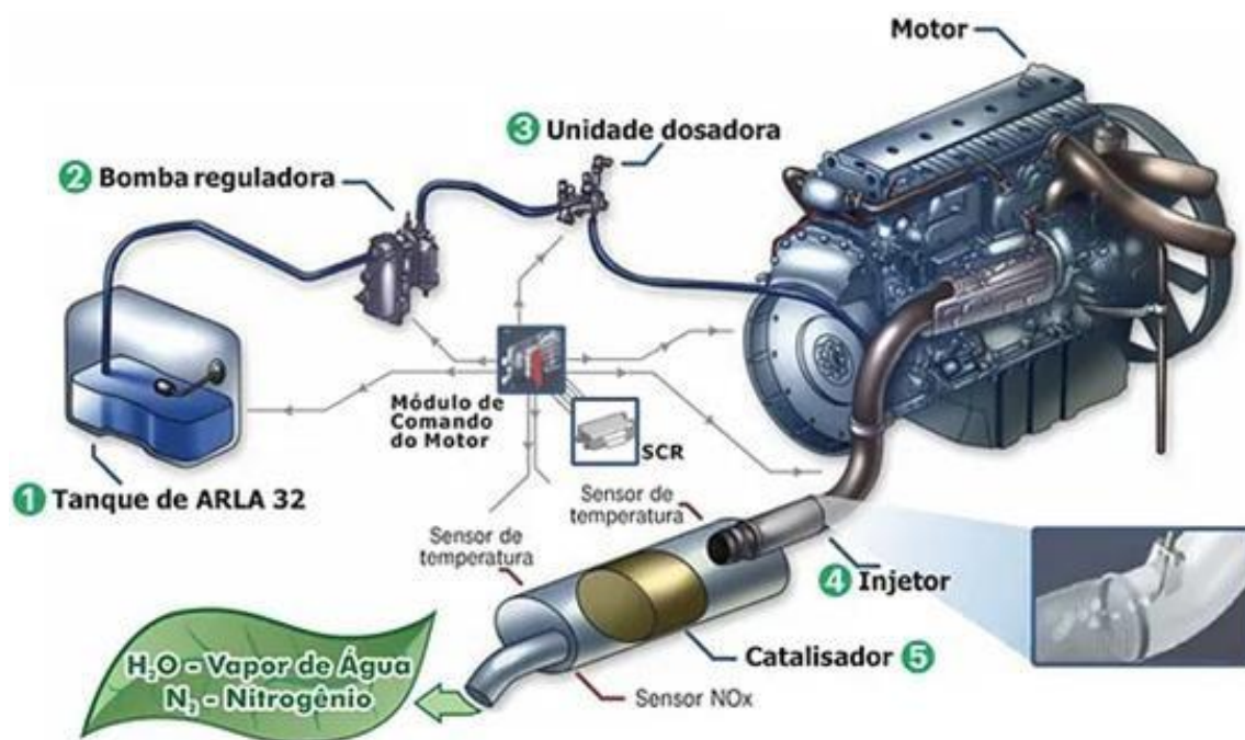
Imagem 2 – Princípio de funcionamento do ARLA 32
