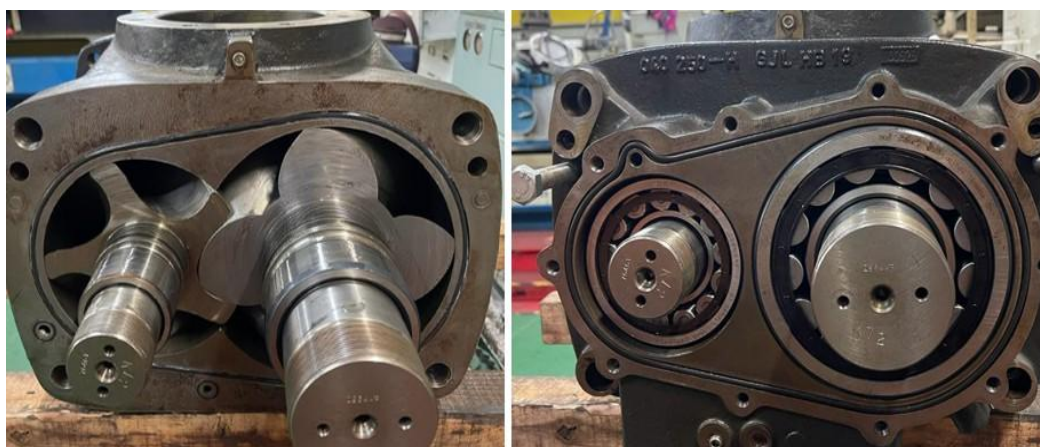
Imagem 9 - Montagem dos fusos na carcaça
