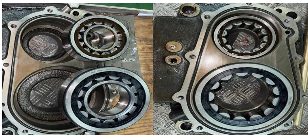
Imagem 8 - Montagem dos rolamentos
