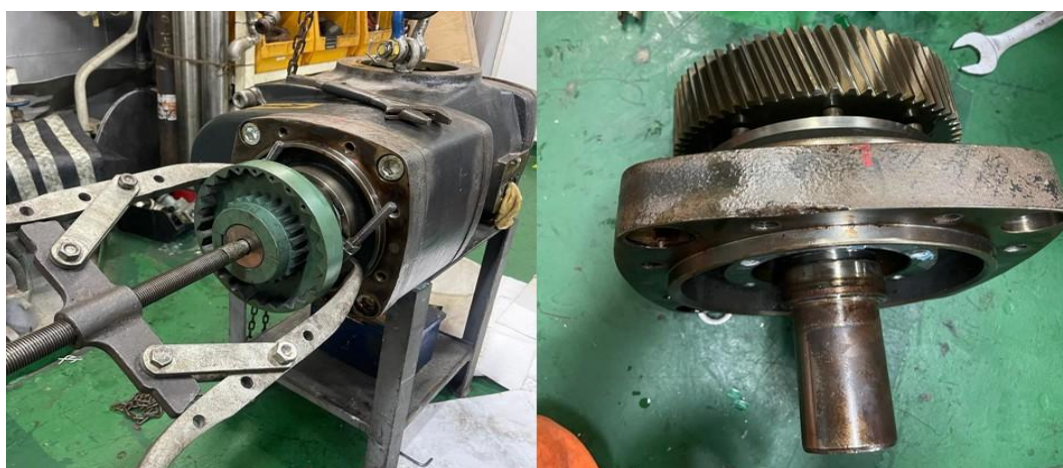
Imagem 5 - Desmontagem da tampa e outros componentes
