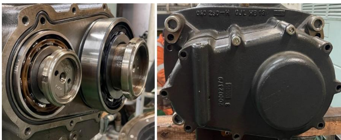
Imagem 10 - Ajuste de folga e fechamento da tampa
