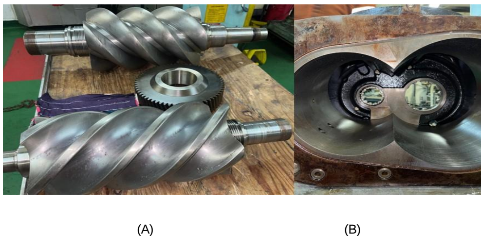
Imagem 7 - Limpeza e inspeção dos componentes internos
