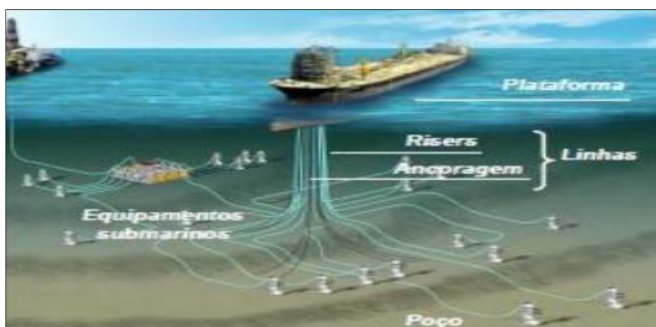
Imagem 8 – Esquema de equipamentos submarinos de produção offshore
