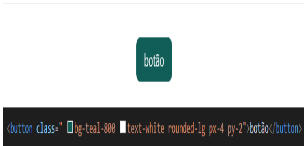
Figura 3 – Criação de um botão HTML com classes do TailwindCSS
