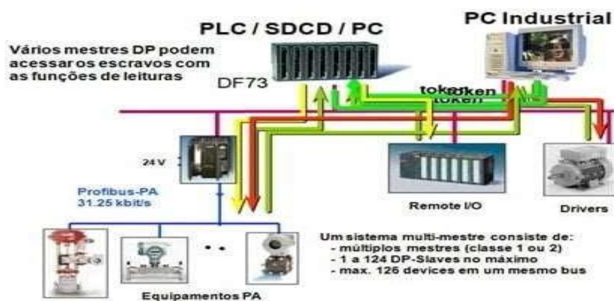
Figura 1 – Esquema de comunicação multi-mestre
