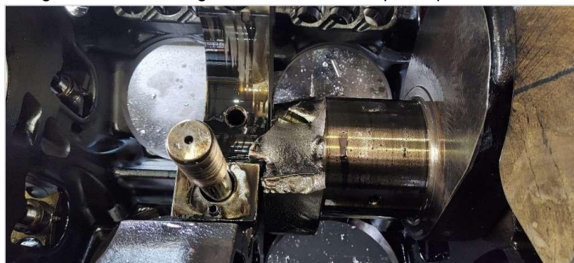
Imagem 9 - Desmontagem do motor diesel após ruptura do eixo virabrequim
