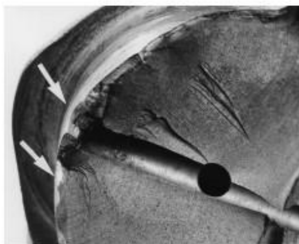
Imagem 4 - Sessão do eixo fraturada em corte
