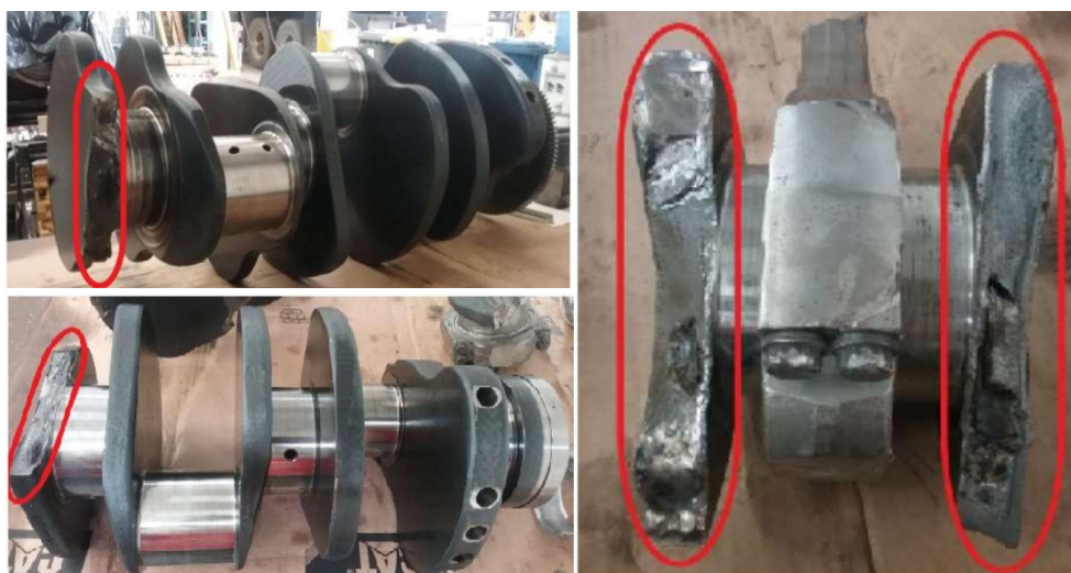
Imagem 5 - Partes do virabrequim fraturado
