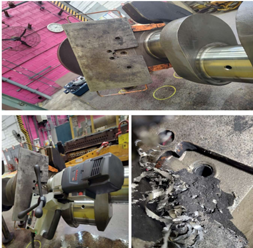
Imagem 11 - Base para fixação da furadeira automática de base magnética em utilização.
