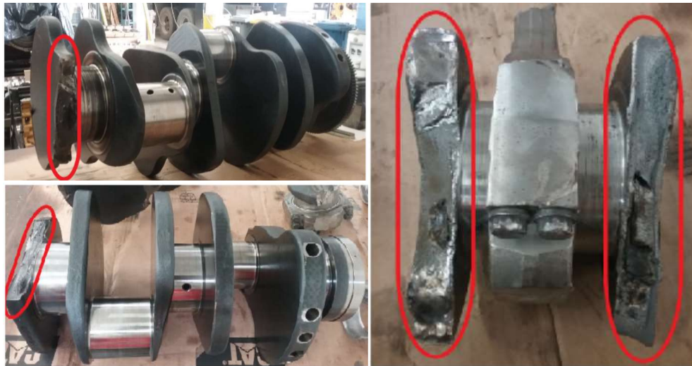
Imagem 5 - Partes do virabrequim fraturado
