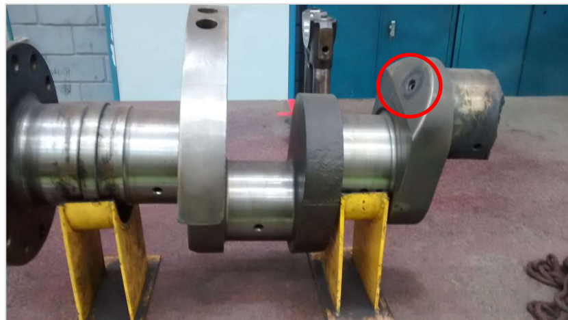
Imagem 7 - Sessão do eixo fraturada em corte evidenciando a área de coloração escura ao redor do bujão.
