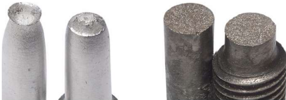
Imagem 1: (a) Fratura do tipo taça e cone em alumínio. (b) Fratura frágil em um aço doce
