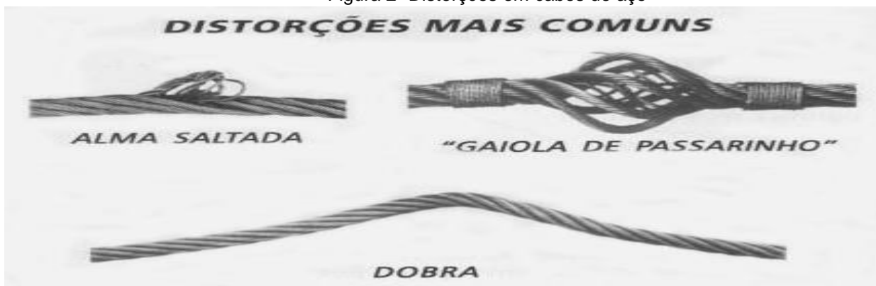
Figura 2- Distorções em cabos de aço
