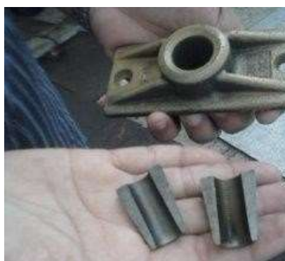
Imagem 16 - Ancoragem em ferro fundido e cunhas bipartidas.
