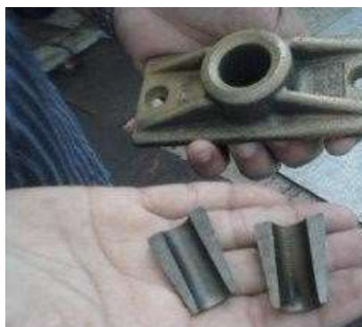
Imagem 16 - Ancoragem em ferro fundido e cunhas bipartidas.
