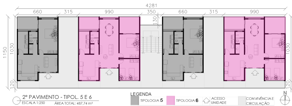
Figura 36: 2º Pavimento Conjunto Habitacional de Interesse Social em Aracruz.
