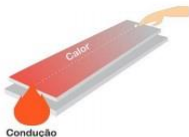
Figura 1- Forma de transmissão de calor por condução
