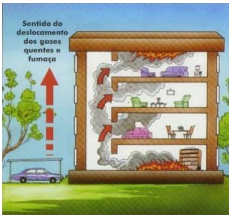
Figura 3- Transmissão de calor por convecção
