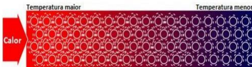
Figura 2- Transmissão de calor de molécula para molécula
