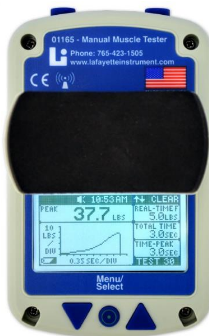
Figura 4: dinamômetro manual Lafayette
