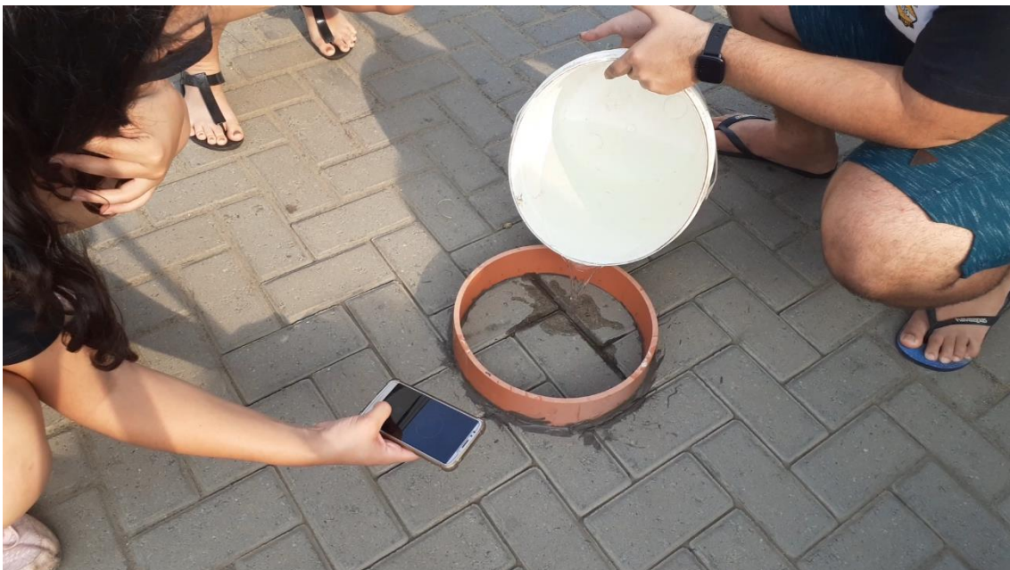
Figura 2: Ensaio para medir a permeabilidade. Fonte: Feito pelo autor
