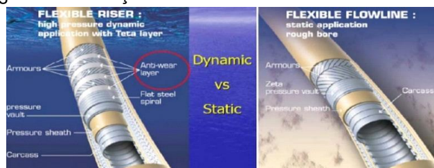
Figura 4: Diferenças construtivas entre “risers” e “flowlines”.
