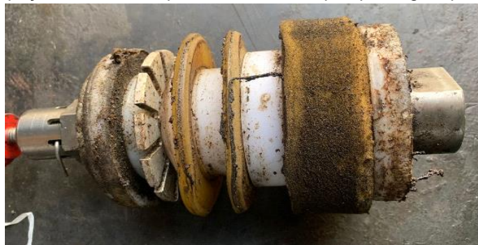
Figura 17: Inspeção do PIG com placa calibradora após passagem pelo duto flexível.
