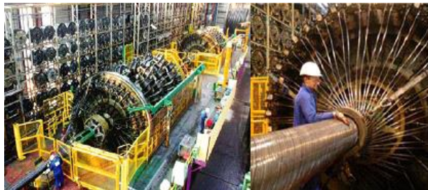
Figura 11: Fabricação das armaduras de tração.
