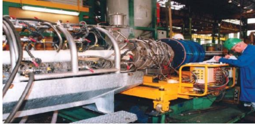
Figura 8: Extrusão da barreira de pressão.
