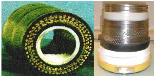
Figura 5: Duto flexível Bonded e Unbonded.
