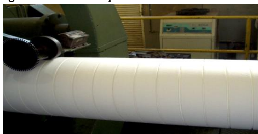
Figura 13: Fabricação do isolamento térmico.
