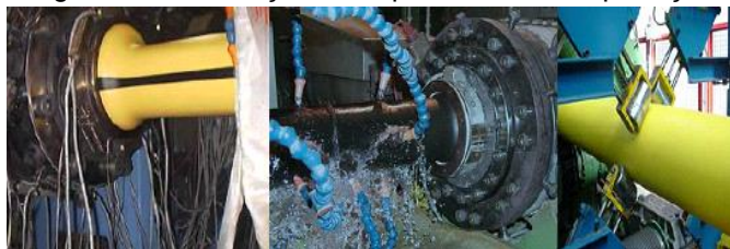
Figura 12: Fabricação da capa externa e de proteção.
