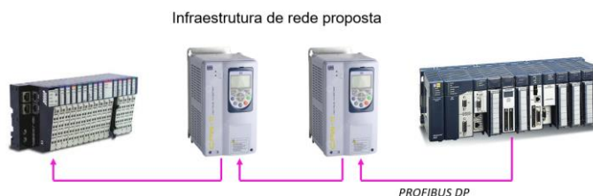
Figura 3: Infraestrutura de rede proposta para adaptação do módulo de expansão de I/O Fonte: Autor
