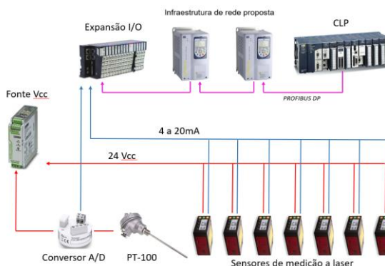
Figura 5: Esquema de ligação elétrica na máquina desenformadora Fonte: Autor
