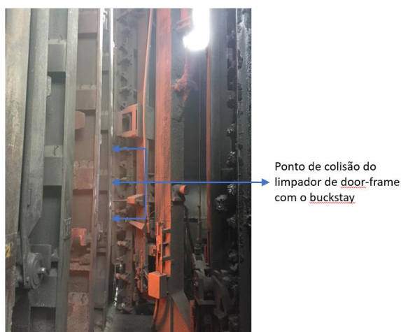
Figura 2: Colisão entre limpador de door-frame e buckstay com a guia de coque Fonte: ArcelorMittal Tubarão – Serra ES, 2019
