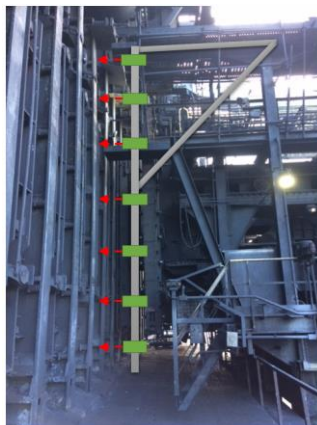
Figura 4: Local de instalação dos sensores de medição a laser na máquina desenformadora
