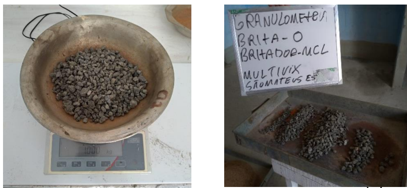
Figura 2: (a) pesagem do agregado graúdo (brita 0) antes do ensaio granulométrico; (b) representação crescente da dimensão dos agregados graúdos. Fonte: Autor (2019)
