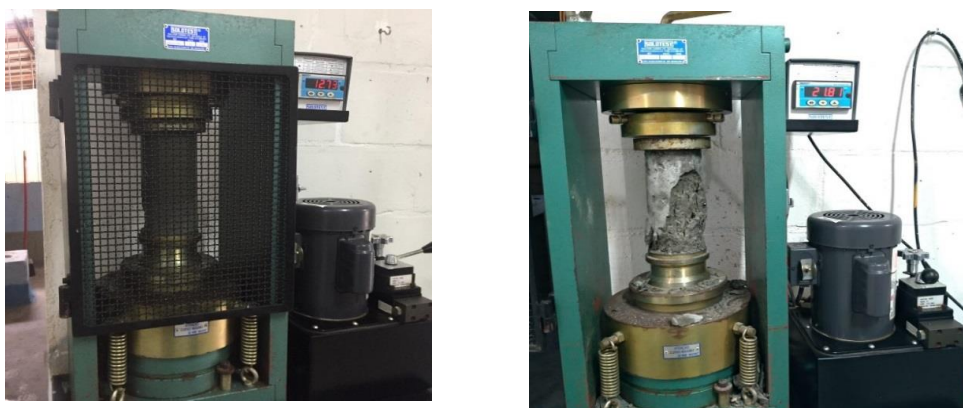
Figura 6: (a) Equipamento para ensaio de compressão axial com grade de proteção; (b) sem a grade de proteção para melhor análise do material rompido. Fonte: Autor (2019)
