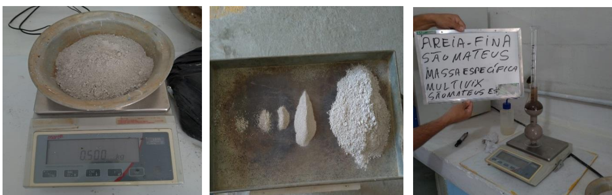
Figura 3: (a) pesagem do resíduo de polimento de placas graníticas; (b) representação das proporções e dimensão dos grãos do resíduo; (c) execução do ensaio de massa específica da areia branca de jazida.
