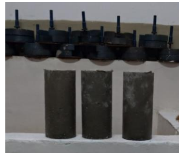
Figura 4: (a) Moldagem dos corpos de prova de concreto (Tipo A e B); (b) Moldagem dos corpos de prova – ensaio pozolânico – de argamassa; (c) Corpos de prova retirados dos moldes com um dia e submergidos em água com cal para cura de 7 e 28 dias; (d) Moldes retirados da cura para realização do ensaio de compressão. Fonte: Autor (2019)
