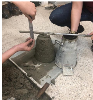
Figura 5: Determinação da trabalhabilidade do concreto “Slump”. Fonte: Autor (2019).
