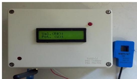
**Figura 1** - Medidor com comunicação móvel
