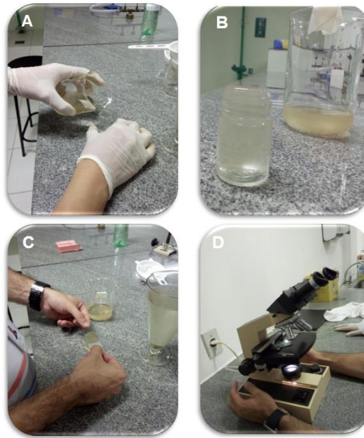
Figura 6: A - Filtrado vertido para o interior do frasco de Borrel. B - Formação do menisco de halo convexo. C - Lâmina sobre o menisco. D - Observação em microscópio. Imagem do acervo pessoal.
