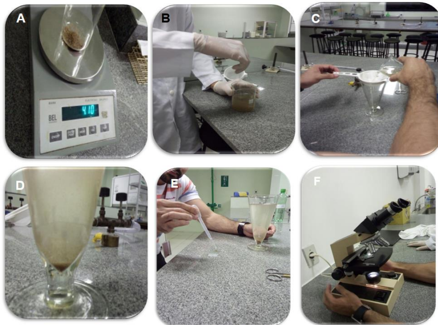
Figura 5: A - Pesagem da amostra para processamento laboratorial. B - Homogeneização da amostra. C - Filtração da amostra. D - Sedimentação espontânea do material após duas horas. E - Coleta de uma alíquota do sedimento entre lâmina e lamínula. F - Observação em microscópio. Imagem do acervo pessoal.
