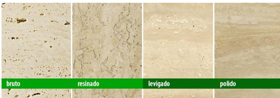
Figura 62– Diferentes tipos de acabamentos realizados no granito
