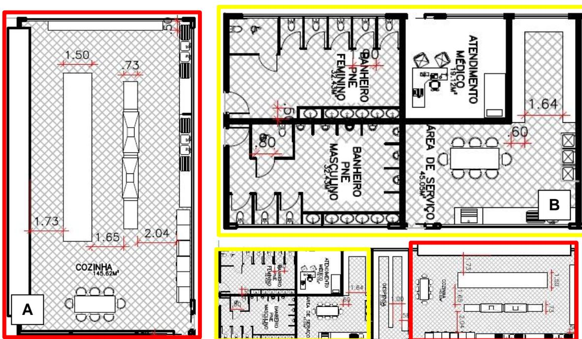
Imagem 55. A) Planta baixa da cozinha – Prancha 4/6 B) Planta baixa dos ambientes do setor de serviço – Prancha 4/6. Fonte: Elaborado pelo autor, 2018.
