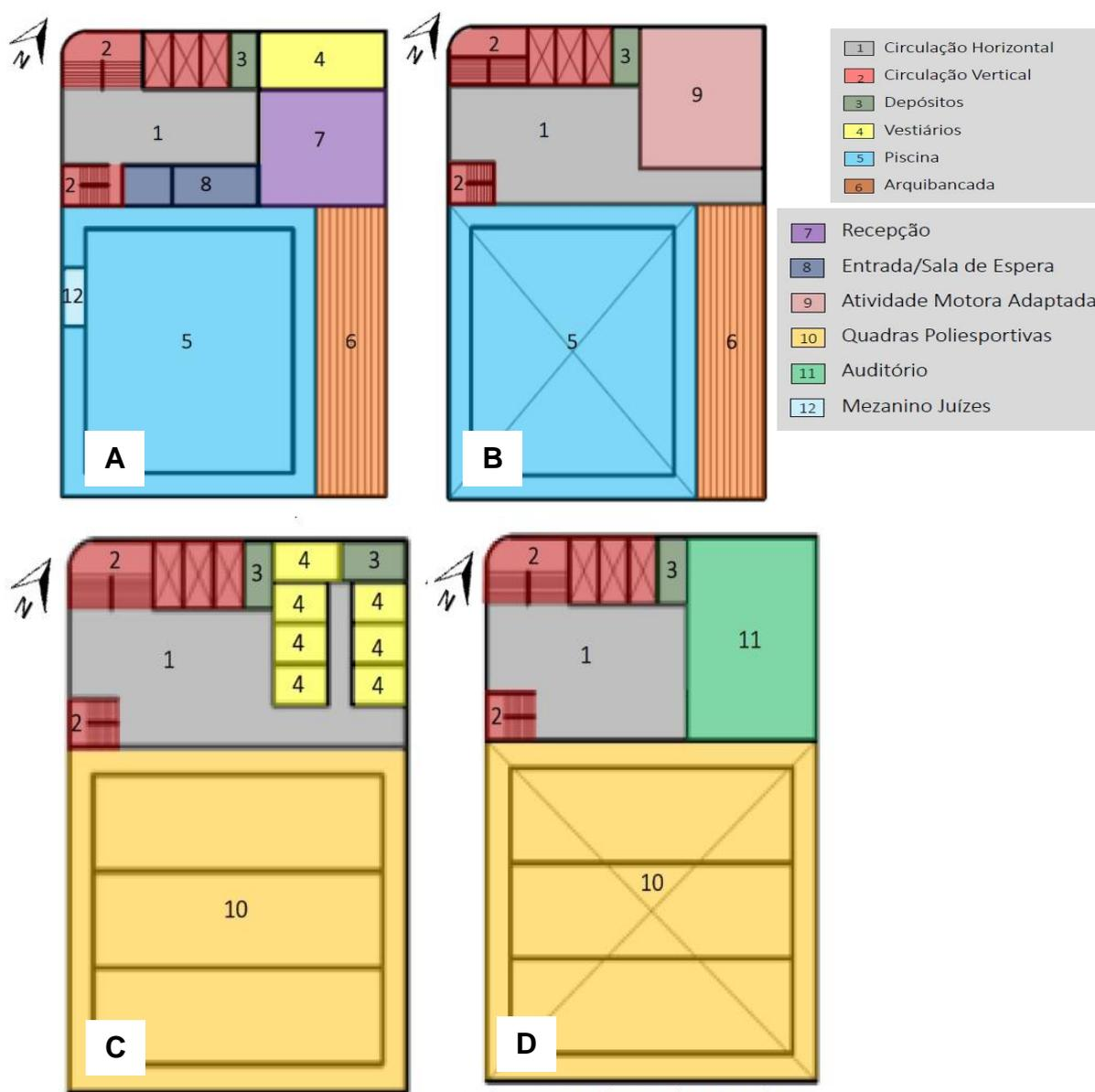
Imagem 33: A) Planta baixa 2º pavimento. B) Planta baixa 3º Pavimento. C) Planta baixa 4º pavimento. D) Planta baixa 5º pavimento. Fonte: Volpato 2018. Editado pelo autor. Acesso em: 11/05/2018.
