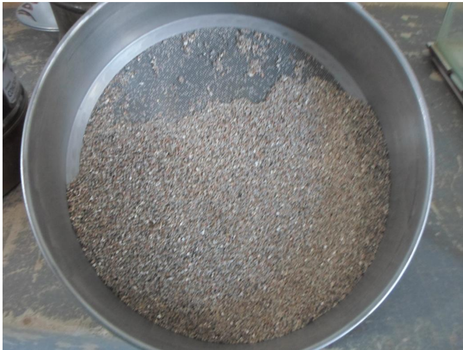
Figura 3: Fração retida na granulométrica peneira nº 10. (Fonte: acervo dos autores)
