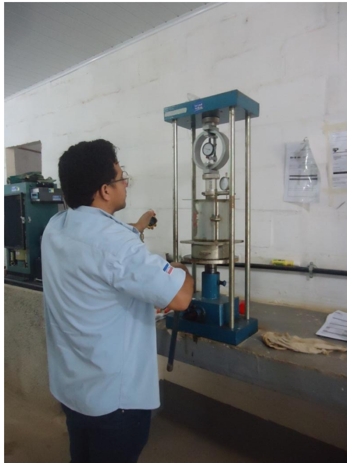
Figura 5: Rompimento do Índice de Suporte Califórnia. (Fonte: acervo dos autores)
