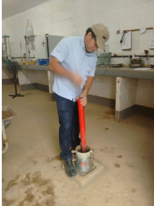
Figura 2: Compactação manual com cinco camadas, obtido 26 golpes cada camada. (Fonte: acervo dos autores)
