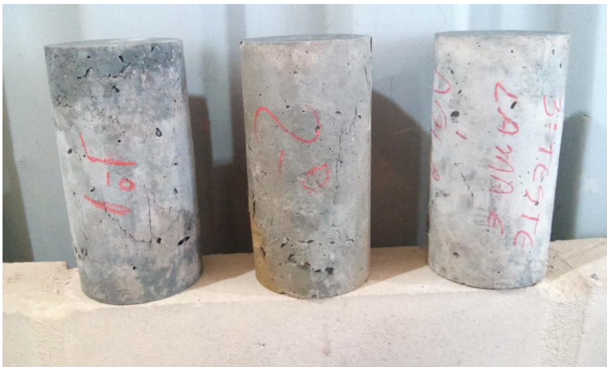
Figura 2 – Corpos de prova após rompimento
