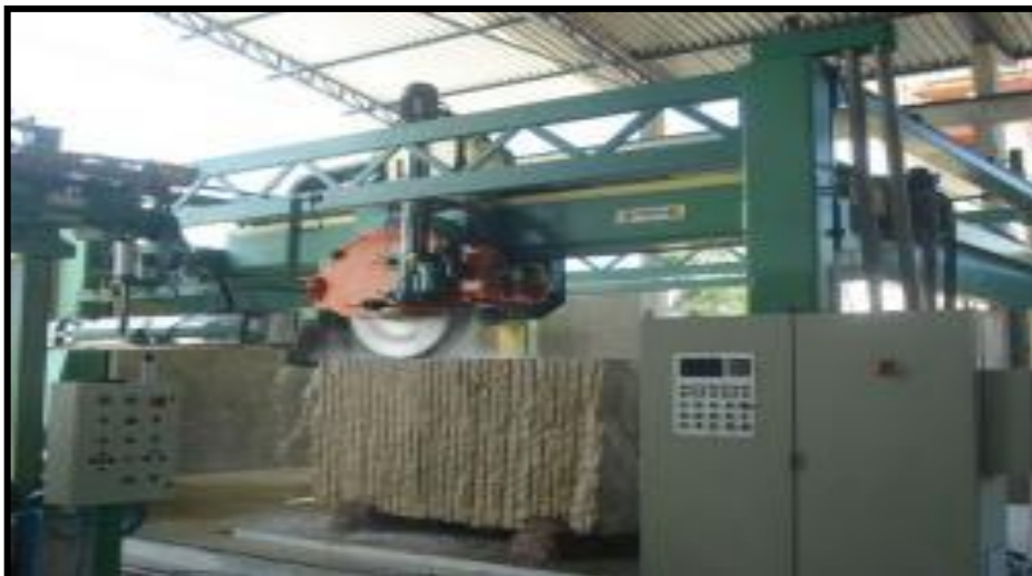
FIGURA 1 - Demonstração do corte de bloco realizado pela Talha - Bloco (Fonte: Revista Inforochas, 2011).
