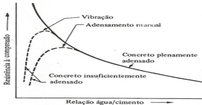
Figura 4 - Influência do adensamento na relação f_c versus a/c - NEVILLE (1997)
