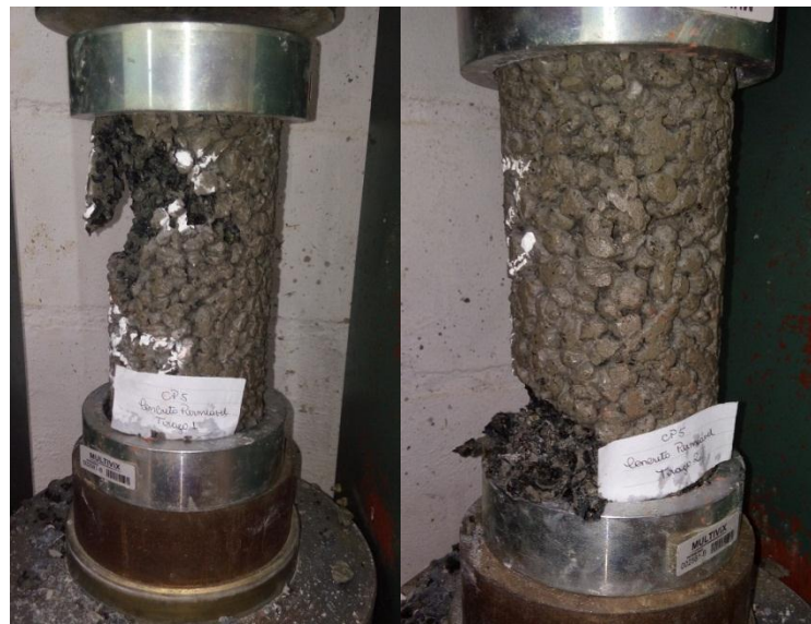
Figura 4 e 5 - Ensaio de resistência à compressão – Traço 1 e Traço 2, respectivamente, aos 28 dias. Fonte: Autores (2017)
