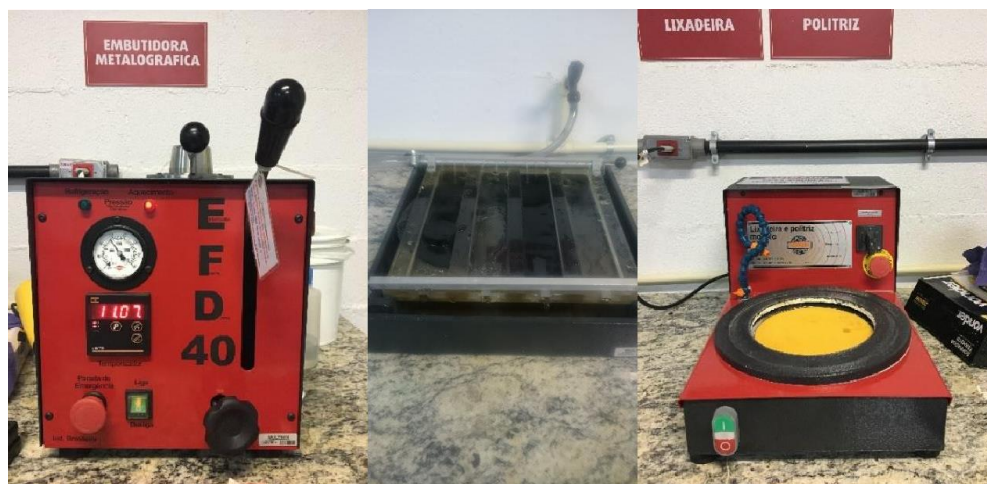
Figura 2 – (a) Embutidora Fortel Digital 40; (b) lixadeira manual; (c) politriz automática.
