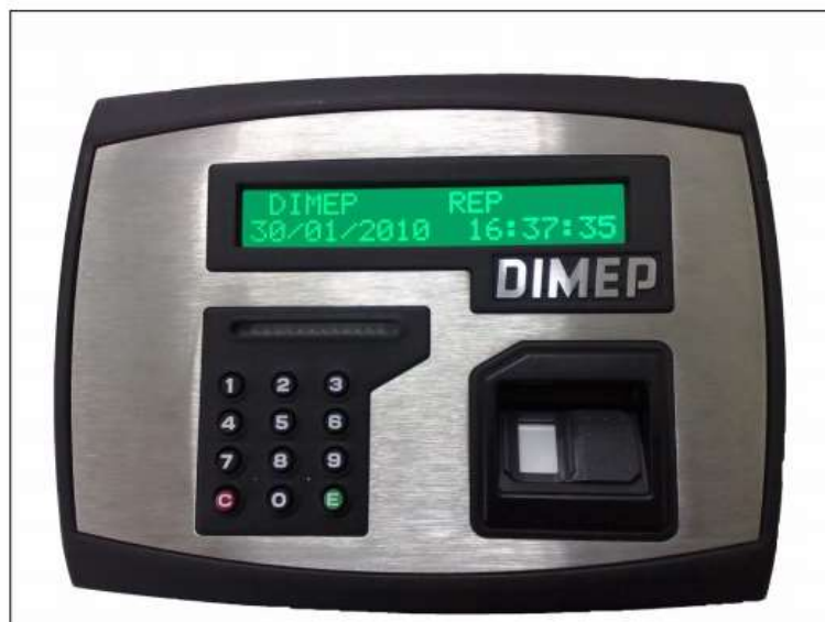
Figura 6 - Frontal do relógio PrintPointII V3
