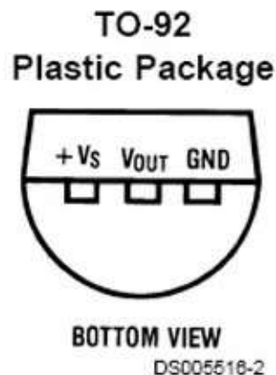
Figura 4 - Conexões do sensor LM 35
