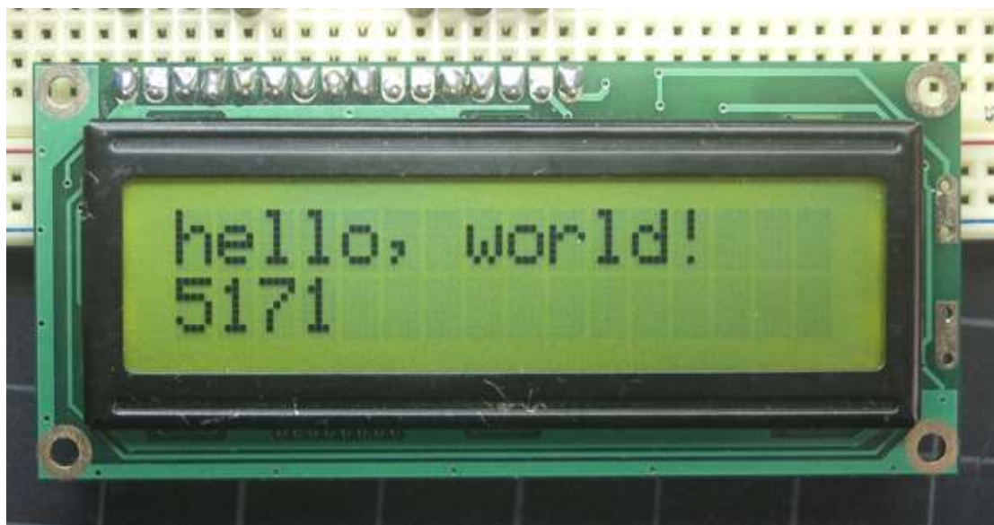
Figura 9 - Display Simples Arduino
