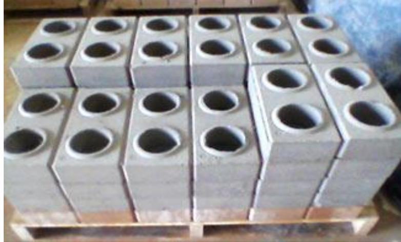
Figura 2.9 – Blocos de concreto reciclados.
