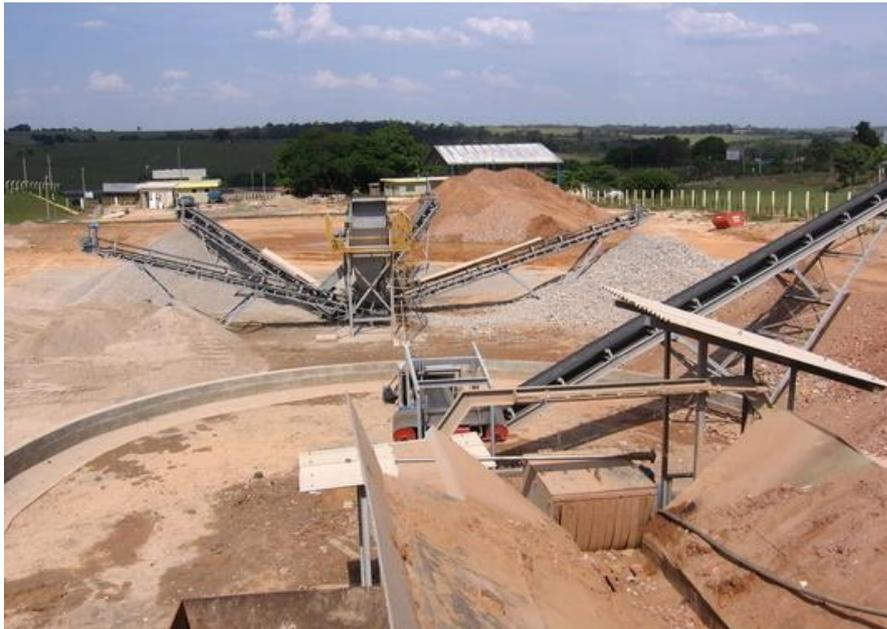
Figura 2.3 – Usina de Reciclagem de RCD's.
