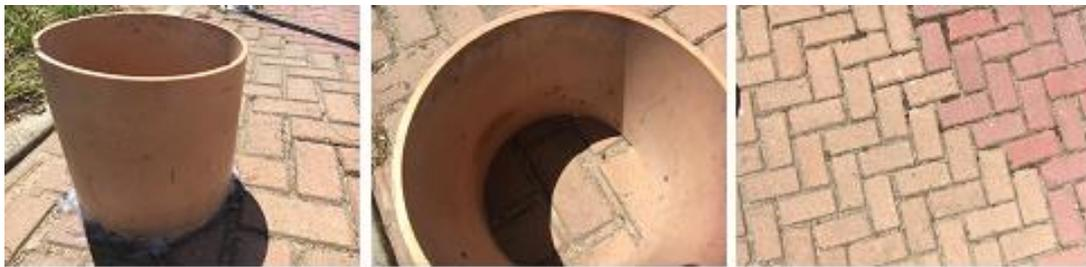
**Figura 7:** Ensaio do Coeficiente de Permeabilidade, praça encontro das águas, Jacaraípe, Serra, Es.
