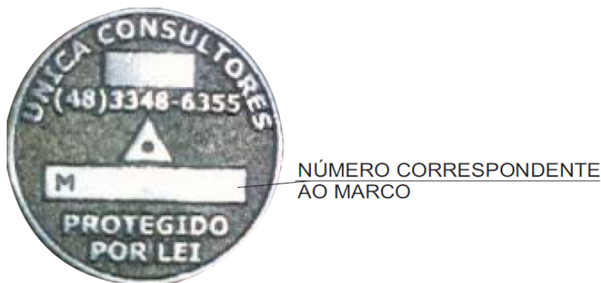
FIGURA 19 - EXEMPLO DE IDENTIFICAÇÃO DO MARCO Fonte: ÚNICA Consultores de Engenharia Urbana, 2012.
