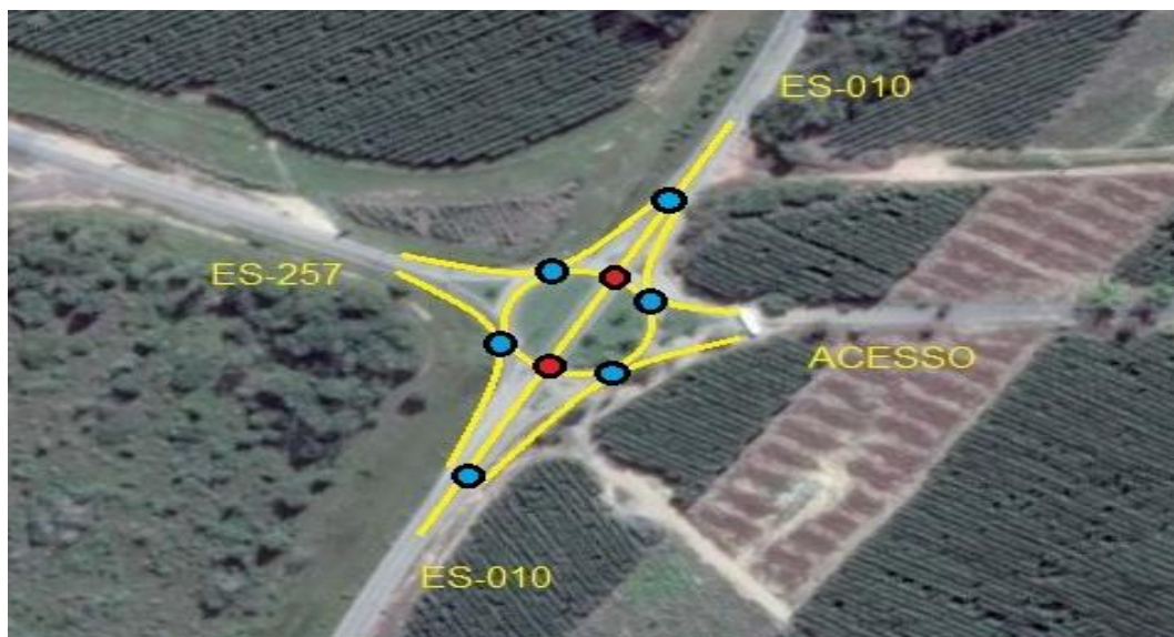
FIGURA 23 - PONTOS DE CONFLITOS DA INTERSEÇÃO EXISTENTE. Fonte: Google Mapas, modificado pelos autores.
