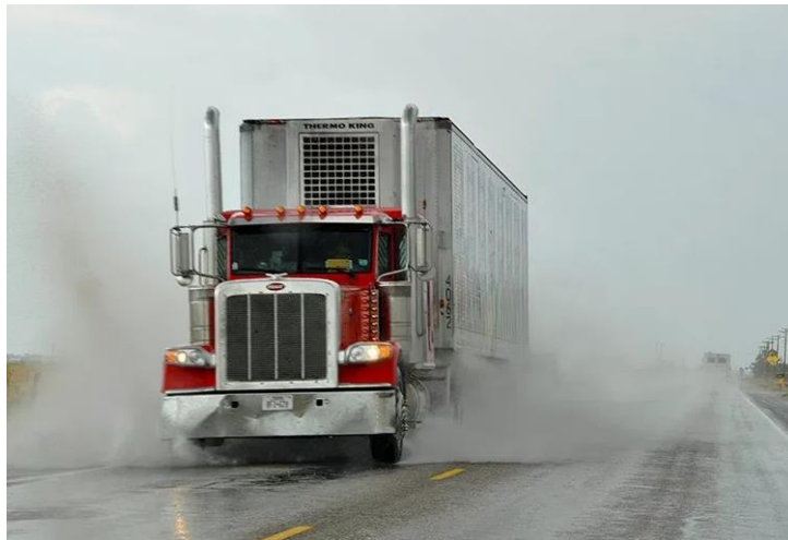
Figura 2 - Spray gerado pela velocidade entre o pneu em contato com a lâmina D'água no asfalto. Fonte: Blog do caminhoneiro, 2016.
