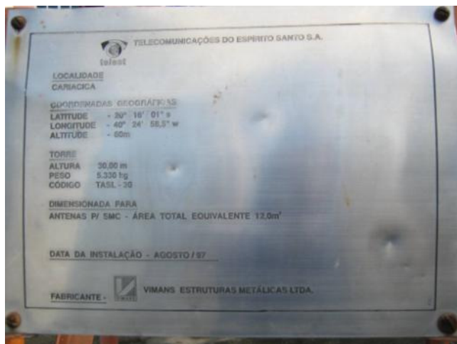
Placa da torre com as informações da implantação e capacidade.
