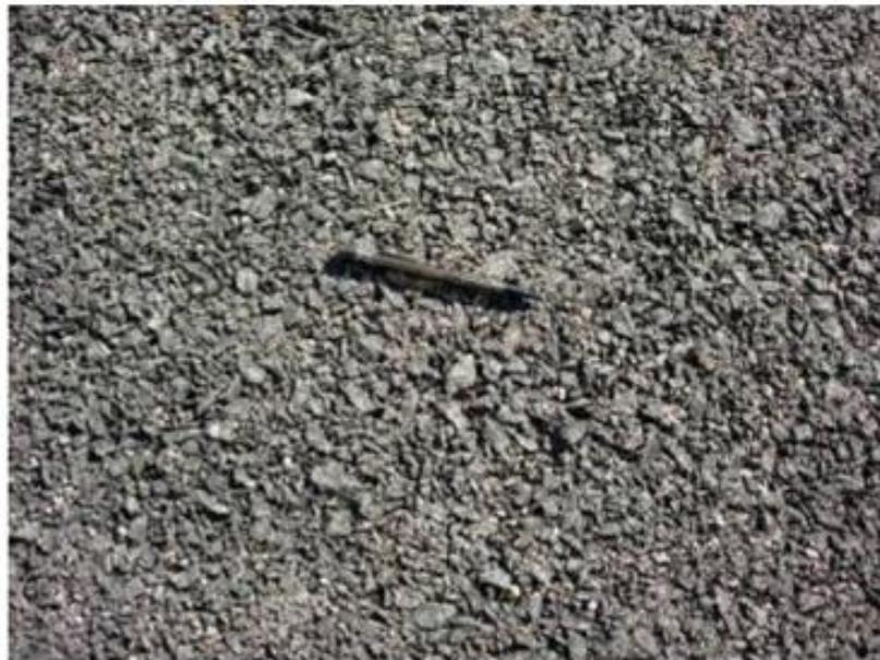
Figura 3: Concreto asfáltico poroso.
