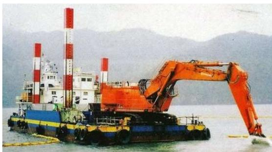
Figura 1: Imagem de uma draga Mecânica.
