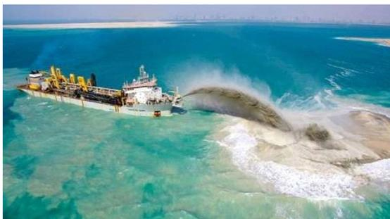
Figura 2: Imagem de uma draga hidráulica.
