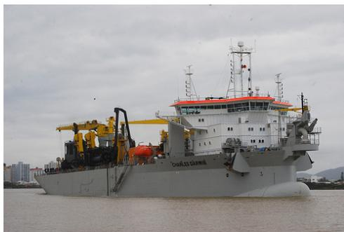
Figura 4: Imagem da draga tipo Hopper operando.
