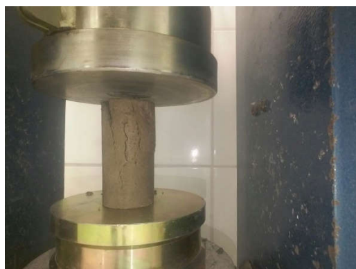
Figura 4: Ensaio de compressão na prensa hidráulica. Fonte: Os autores (2017).
