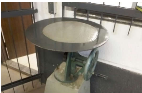
Figura 2 - mesa de abatimento da argamassa e medição dela com o paquímetro. Fonte: Os autores (2017).
