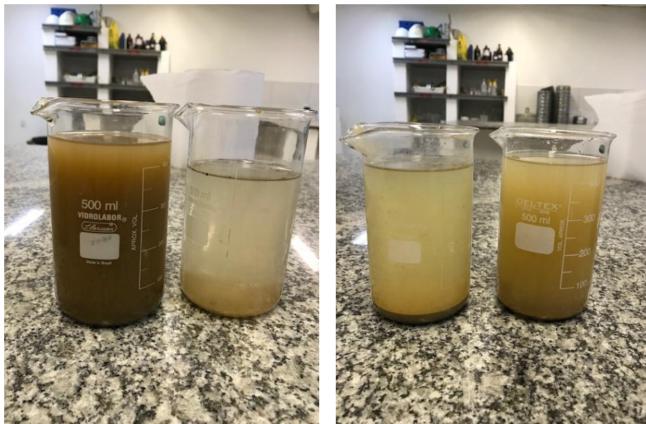
Figura 4.5 – Ensaio material pulverulento, comparação da água de lavagem inicial e final da areia natural e reciclada respectivamente. Fonte: Autor.
