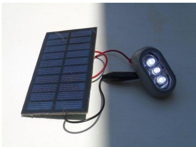
Figura 2: Interligação do painel solar com as lâmpadas de LED
