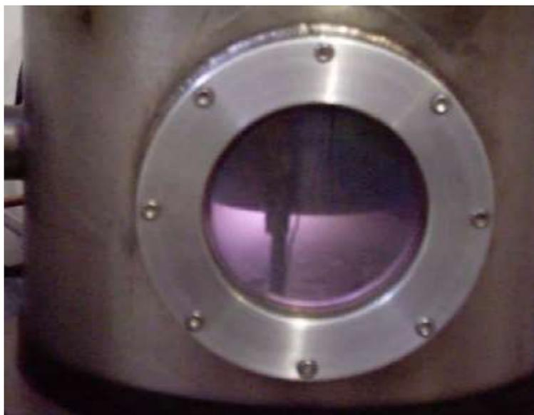
Figura 1 – câmara de *sputtering* em funcionamento. O interior lilás é a coloração do plasma de argônio.
